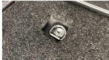
② 固定ボルトを緩め、車両フック取り外します。
