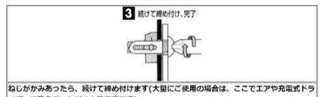
ねじがかみあつたら、続けて締め付けます(大型にご使用の場合は、ここでエアや充電式ドライバーに換えていただくと効率的です)
