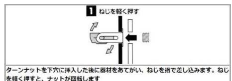
ターンナットを下穴に挿入した後に器材をあてがい、ねじを指で差し込みます。ねじを軽く押すと、ナットが回転します
