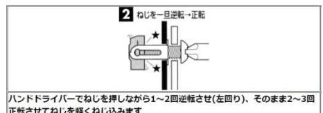
ハンドドライバーでねじを押しながら1~2回逆転させ(左回り)、そのまま2~3回正転させてねじを軽くねじ込みます
